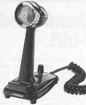
LESON tafelmikrofoon met ingebouwde regelbare voorversterker. Impedantie 600 Ohm of 50 kOhm. versterking 0 - 12dB regelbaar gevoeligheid: - 40dB. voeding d.m.v. batterij. Prijs: f 108,-
